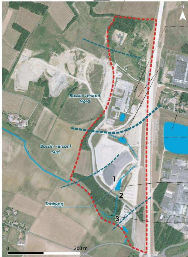
Sous-bassin versant Nord constitué d'une ancienne carrière et d'emprises artificielles (anciennes plates-formes des bâtiments de la base travaux, poste électrique...). Actuellement, les eaux pluviales de ce secteur ne sont pas ou plus collectées. Il faudra envisager de nouveaux équipements de gestion pluviale dans la perspective d'aménagement du site.
