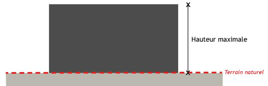
*Calcul de la hauteur en fonction de la configuration du terrain*
