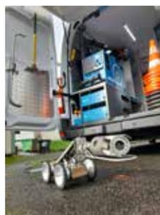
Grâce à cet équipement, les agents, aux commandes d'une caméra téléguidée, contrôlent l'état des canalisations d'eaux usées et d'eaux pluviales, détectent et localisent les problèmes d'écoulement et d'infiltration d'eau. Un rapport d'investigation permet ensuite de
