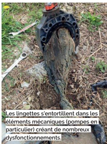
Les lingettes s'entortillent dans les éléments mécaniques (pompes en particulier) créant de nombreux dysfonctionnements.
